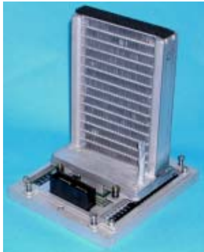
沸騰冷却器を取付けた CPUパッケージ
